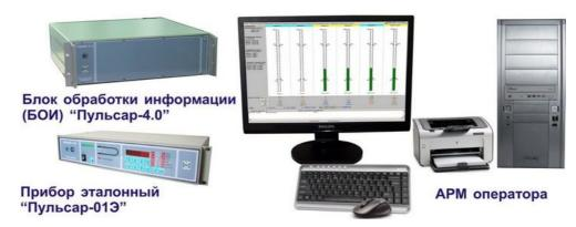
СОИ «Пульсар-С2» по назначению и функционированию аналогична СОИ "Пульсар-С1. Отличие в конструктивном исполнении - БОИ "Пульсар-3.2" и контроллеры объединены в одном блоке - БОИ "Пульсар-4.0".
